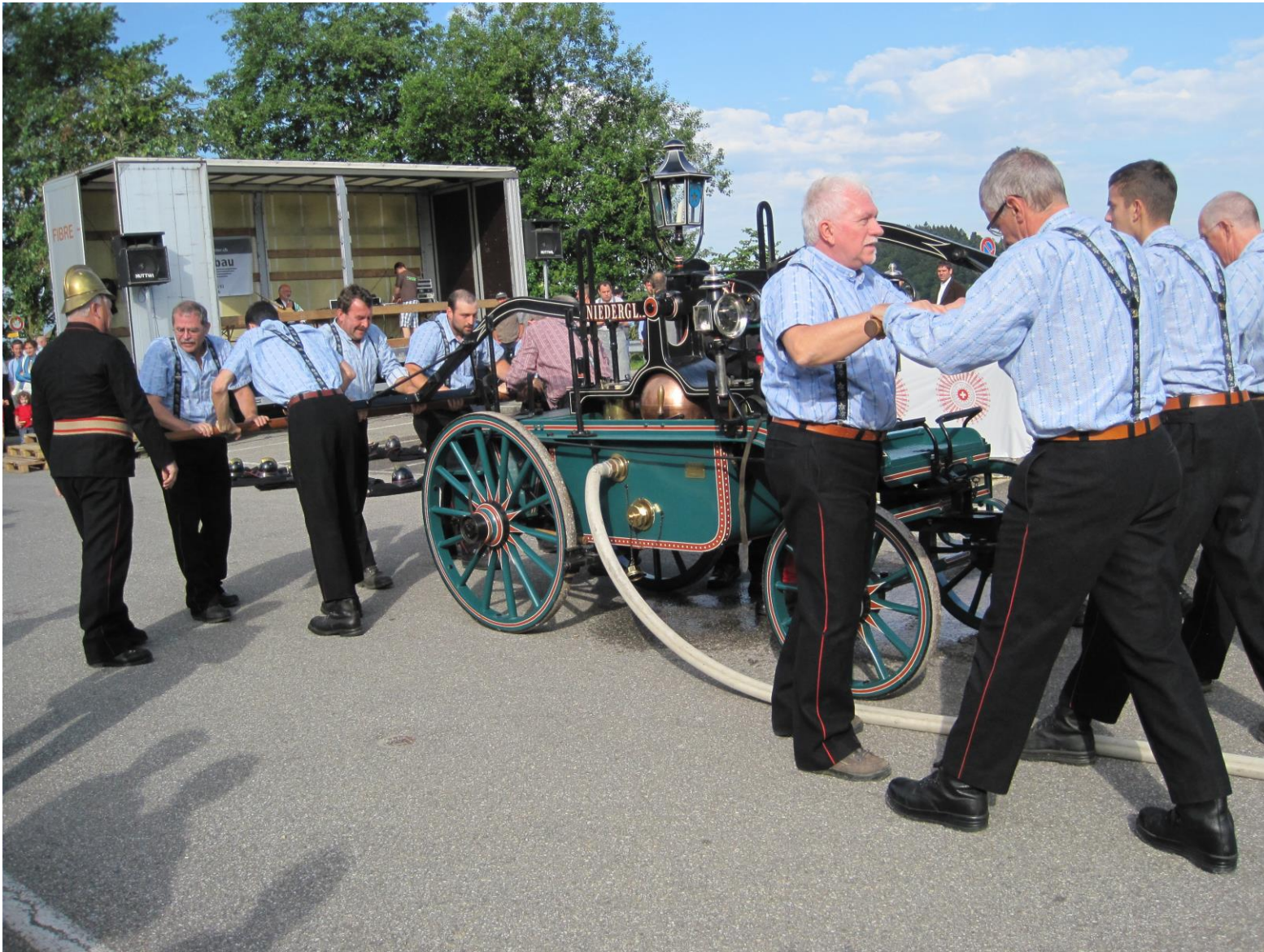
Beim Pumpen an der Handdruckspritze ist körperlicher Einsatz gefragt. Theoretisch könnte die Handdruckspritze des Feuerwehrvereins Niederglatt 489 Liter Wasser pro Minute spritzen, dazu müssten die zwölf Männer an der Pumpe aber jede Sekunde einmal pumpen. Eine so hohe Kadenz wird in der Praxis selten erreicht.
